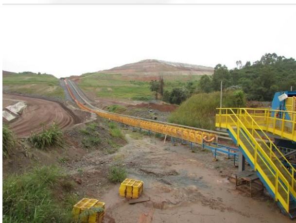
Figura 03 – Detalhe para a instalação da correia rente ao solo.
