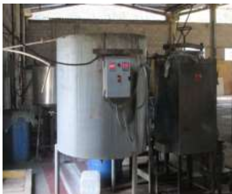
Figura 2: Sistema de reciclagem do solvente sujo
