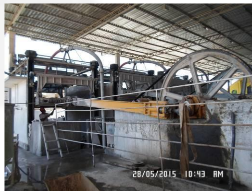
Foto 06: Tear que utiliza lama abrasiva
