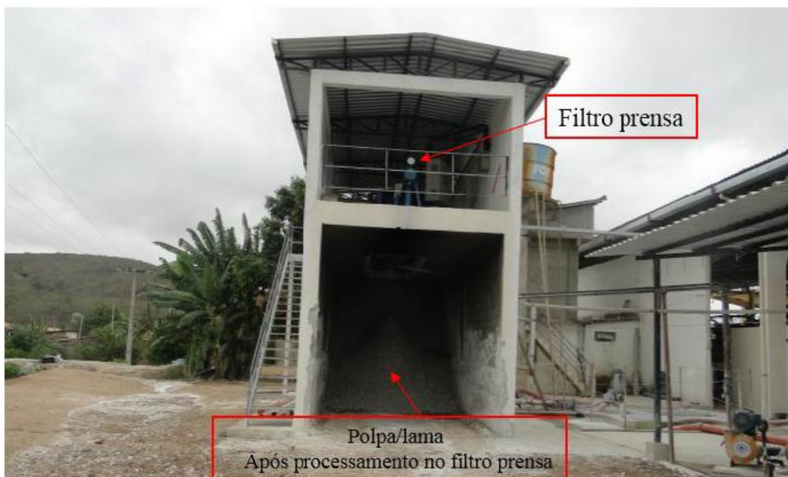
Foto 3 – Indicando o local onde é liberada a polpa/lama após passar pelo filtro prensa
