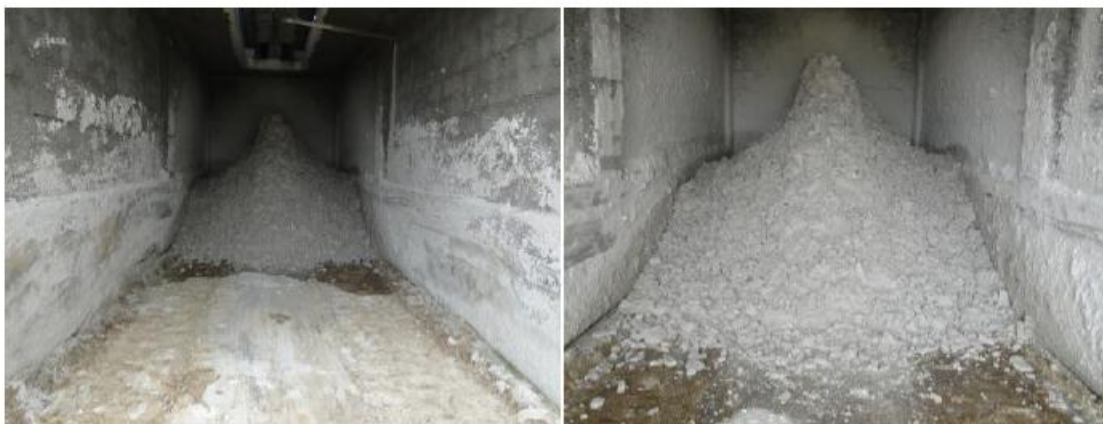
Foto 4 – Polpa/lama resultando do filtro prensa
