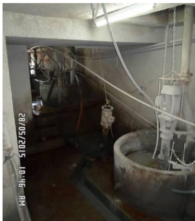
Foto 07: Parte inferior de um dos teares que utilizam lama abrasiva
