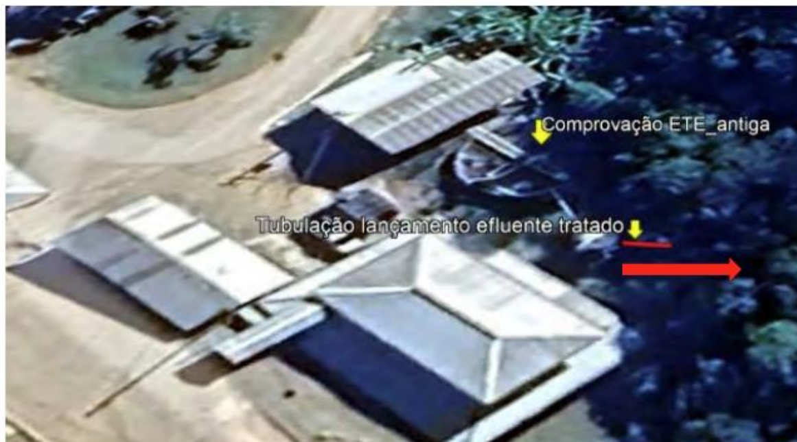
Figura 1- ETE antiga, tubulação direcionada ao curso d'água sem denominação. Fonte: Google Earth 2025 e SLA.
