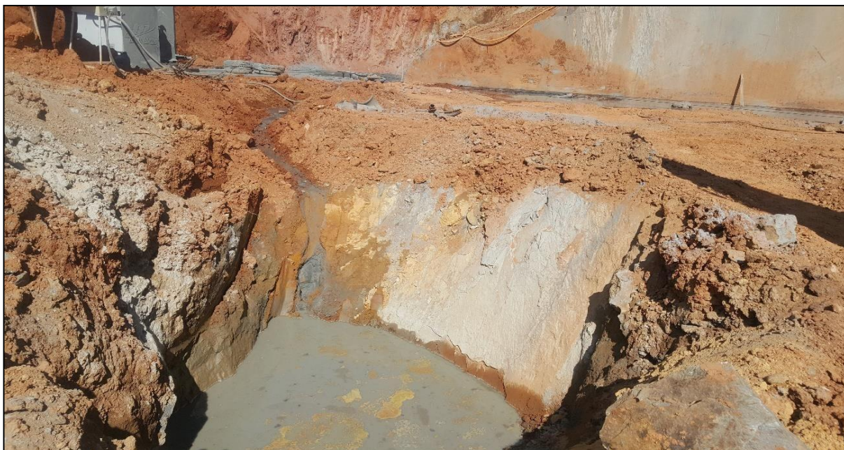
Imagem 4: Bacia de sedimentação da frente de lavra para direcionamento do efluente proveniente do corte da rocha, página 07 do Relatório Fotográfico apresentado
