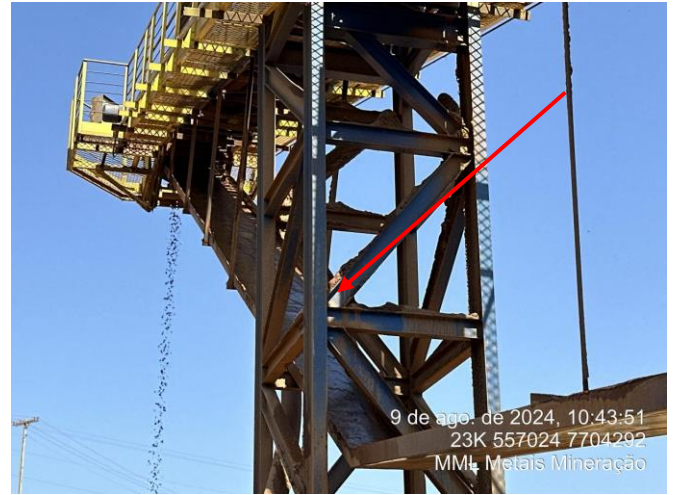
Foto 6: Efluente advindo da umectação das peneiras, que escoo por canaletas.
