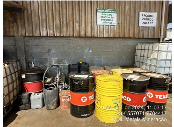
Foto 30: Possível observar o armazenamento de produtos químicos juntamente com resíduos.
