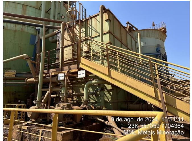
Foto 8: Outro tanque que recebe os efluentes advindos da UTM, antes de serem direcionados aos ciclones.
