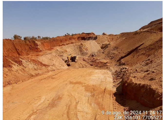
Foto 2: Cava 97, localizada próxima às coordenadas UTM 23k 554498 / 7706204. A direita da foto pode ser verificada a formação de taludes de estéril depositado, preenchendo parte da cava.
