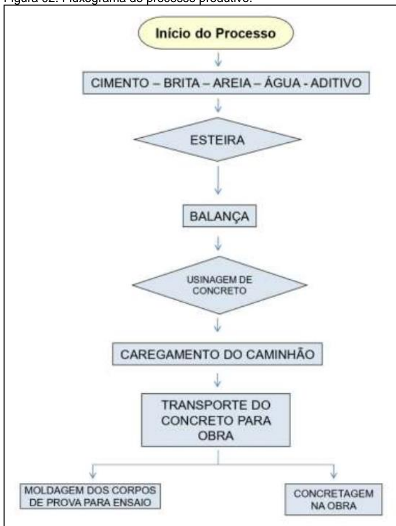
Figura 02: Fluxograma do processo produtivo.
