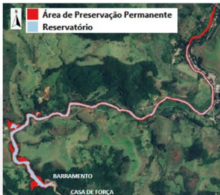
Figura 16 - Ilustração da Área de Preservação Permanente (APP) do reservatório da CGH Paciência, diferença o nível máximo operativo normal e a cota máxima maximorum . Fonte: Cemig, 2024.
