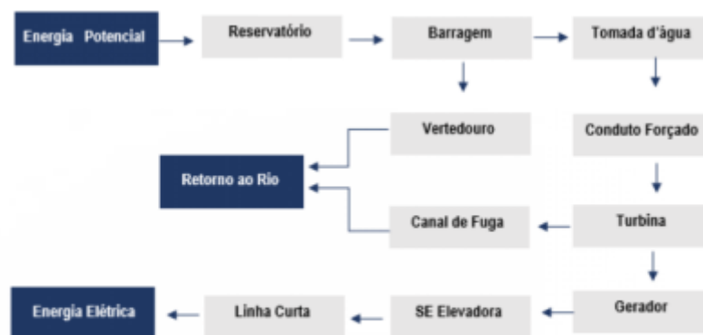
Figura 6-2. Fluxograma do processo produtivo de geração de energia. Fonte: CEMIG, 2022. Elaborado por Clam, 2022.
