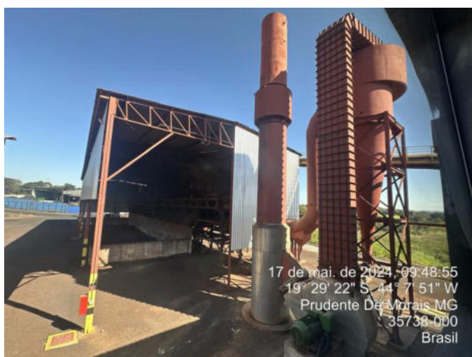
Foto 33: Filtro ciclônico que compõe a estrutura fabril
