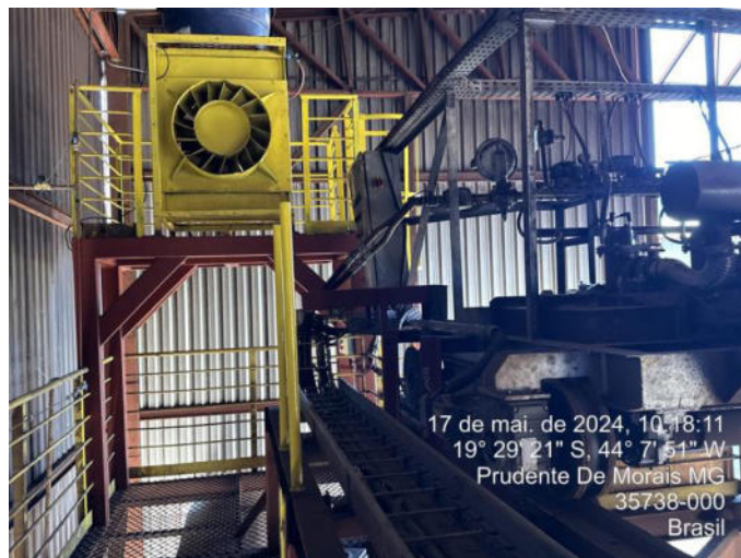
Foto 38: Sistema de aspersão instalado no descarregamento das pelotas
