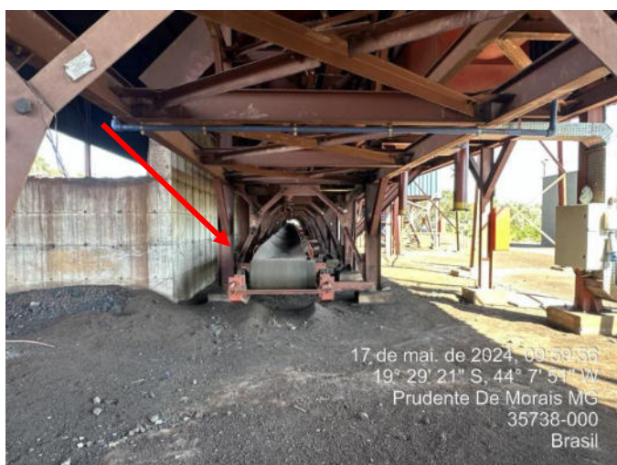
Foto 35: Esteira na parte inferior das estruturas para coletar os possíveis materiais advindos do processo, evitando que fiquem dispostos direto no chão
