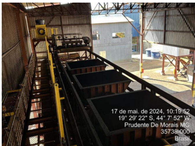
Foto 37: Parte interna do galpão de pelotização, o qual despeja o material dessas "panelas" para esfriarem no solo. Foi instalado sistema de aspersão nessa área
