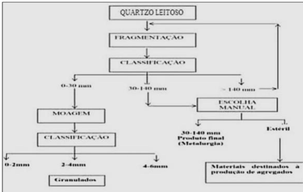
Figura 3: Método de lavra do quartzo.
