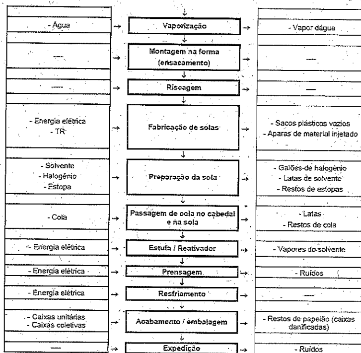
Figura 2 Diagrama de blocos, ilustrativo do fluxograma do processo - calçados.
