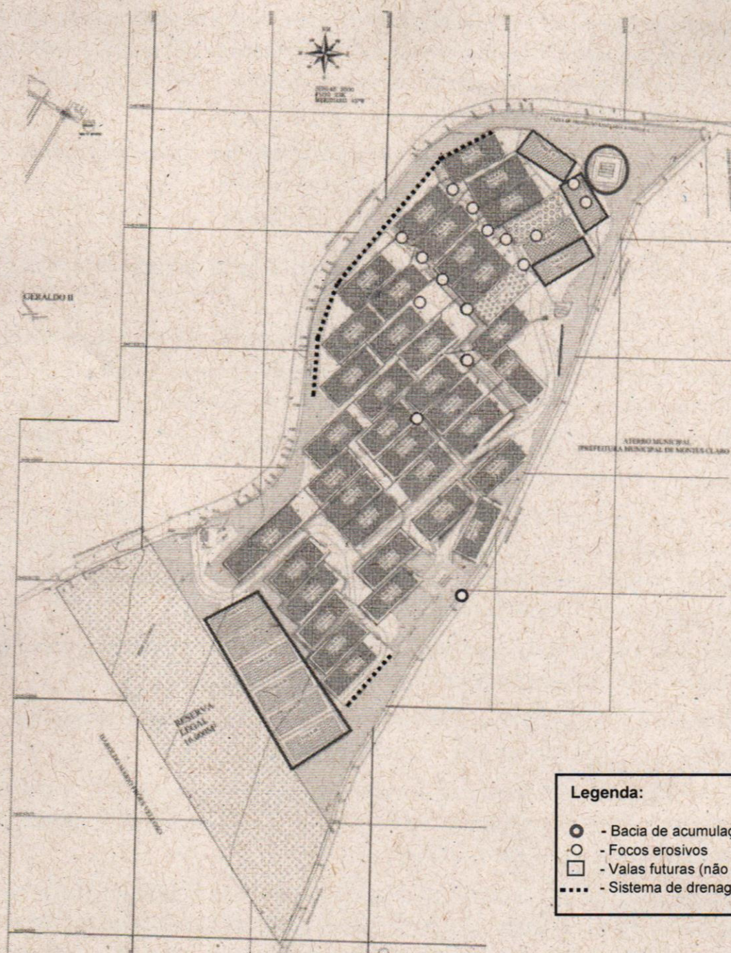
Figura 7 – Ocorrências verificadas na vistoria devido a ausência ou irregularidades no sistema de drenagem de águas pluviais. – Fonte: RADA - editado .
