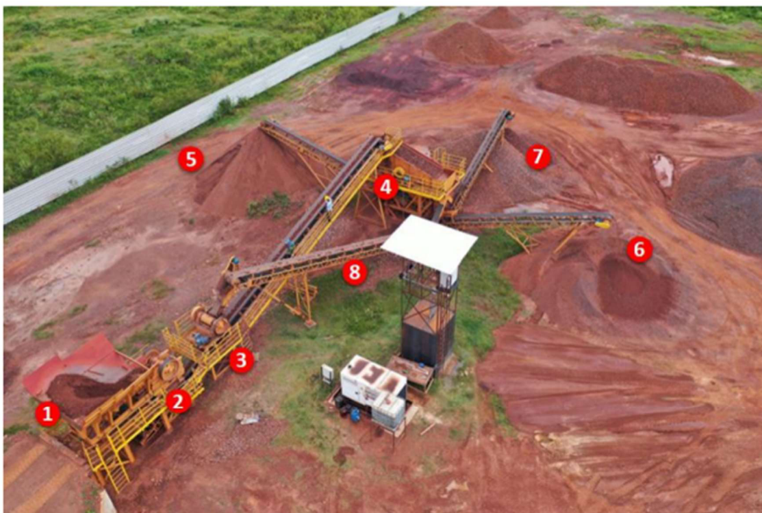
Foto 1. Itens que compõem uma Unidade de Tratamento de Minério (UTM) a seco que poderá ser utilizada no empreendimento.
