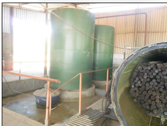
Foto 01. Auto clave e tanques de solução preservativa inseridos em bacia de contenção.
