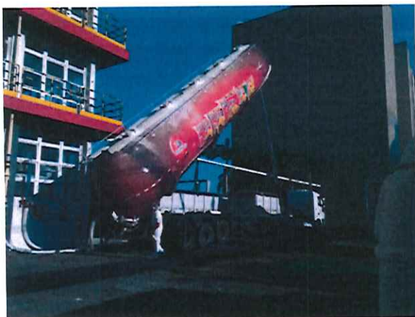
Figuras 3 e 4: Exemplo de descarregamento de matéria prima, em unidade já implantada, recebida pela via rodoviária.
