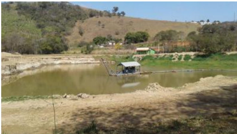
Foto 01. Draga realizando a sucção no centro da cava aluvionar.
