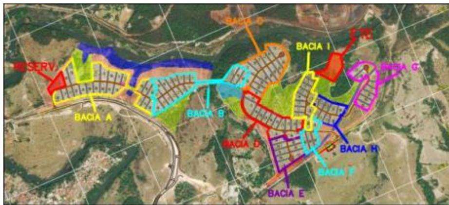
Imagem 11: Mapa esquemático das sub-bacias de contribuição para o terceiro estudo de concepção. Fonte: RCA.
