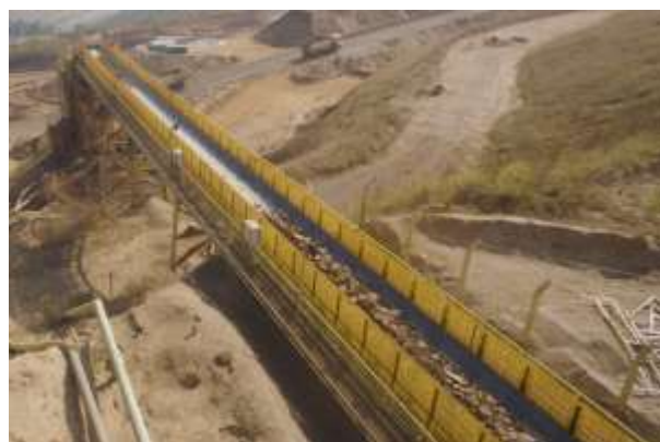
Figura 4 - Saída da lama transformada em torta, já triturada
