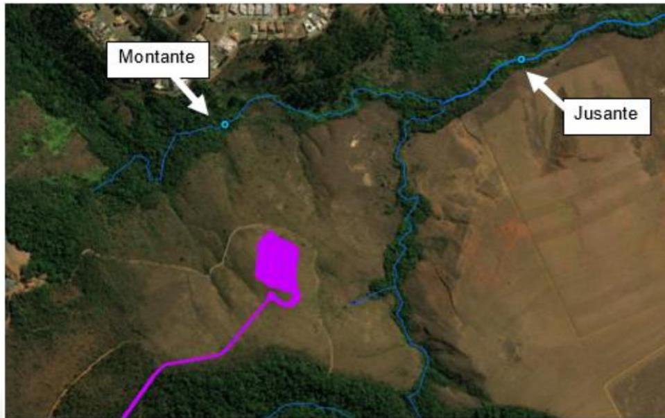
Figura 5: localização dos pontos propostos para o monitoramento de qualidade das águas à jusante e à montante do ponto de lançamento dos efluentes tratados. Fonte: Informações Complementares, MYR Projetos Sustentáveis, 2021.
