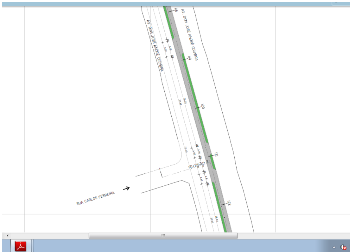
Figura 02: Vista de um trecho da obra do canteiro central das avenidas – trecho em cinza é a calçada. E o trecho em verde é grama - onde estarão plantando as árvores.
