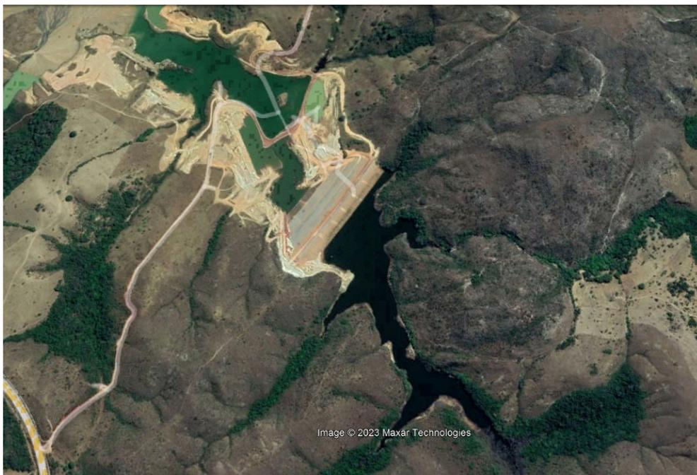
Figura 4- Vista aérea do eixo da barragem relocada, sendo o reservatório a montante Sabão II e a jusante Sabão I. Fonte: Google Earth (2023)
