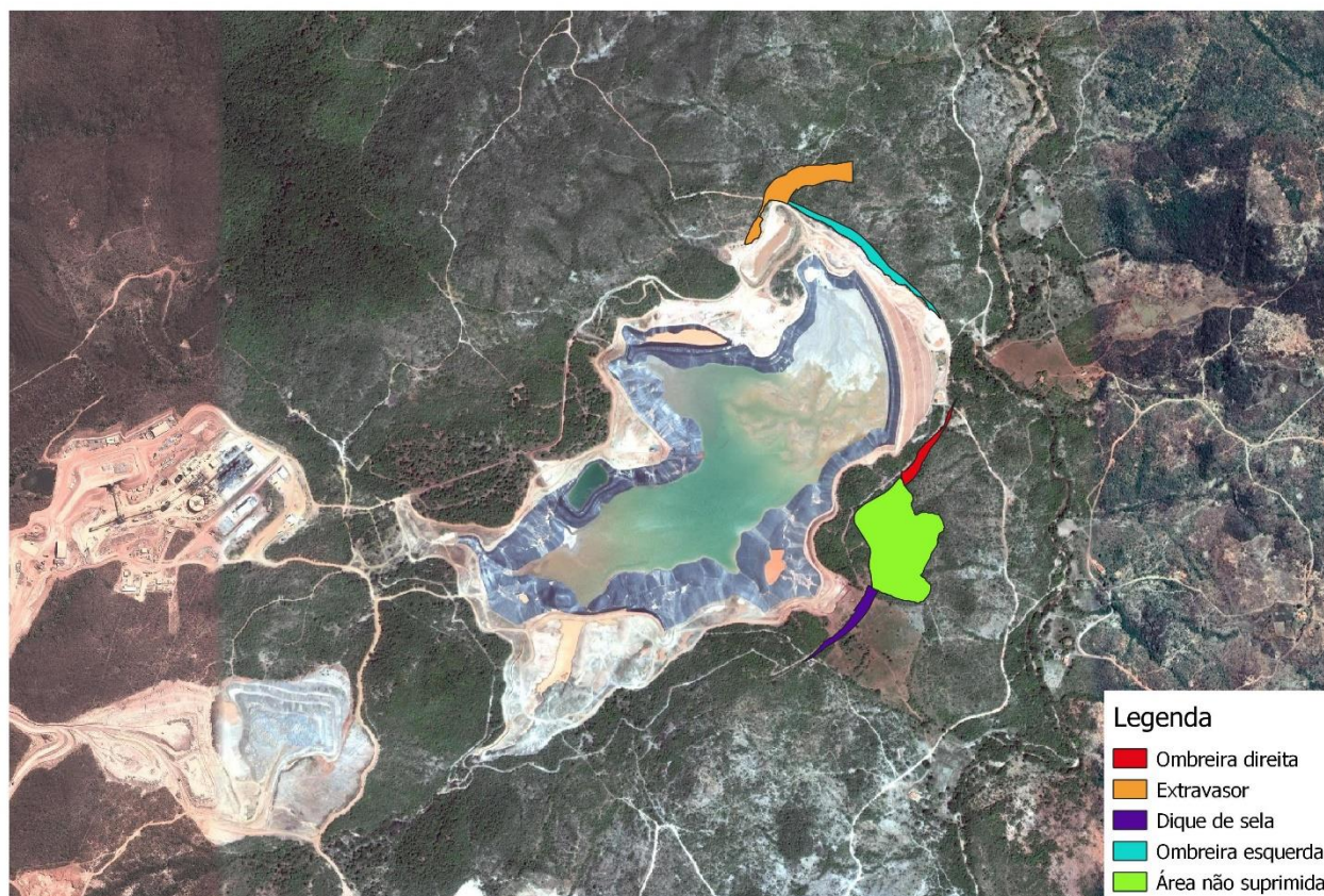
Figura 2 Áreas de intervenção e área que será preservada, pela mudança de forma de alteamento. Fonte: Informações complementares.
