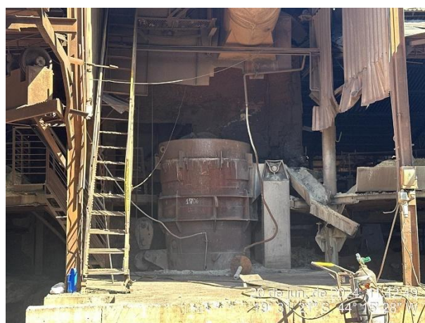
Foto 4: Estrutura a qual ocorre a metalúrgica de panela.
