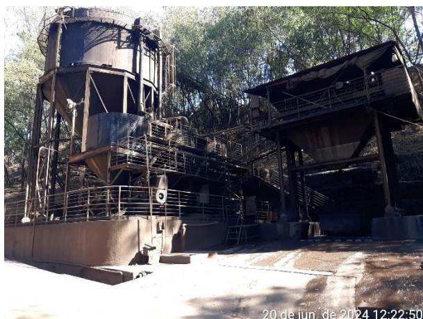
Foto 101: Estrutura do filtro prensa com o tanque de espera de lama de pó de balão na parte alta à esquerda da foto.
