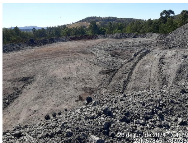
Foto 82: Parte alta da pilha, com indícios de deposição de escória recente.
