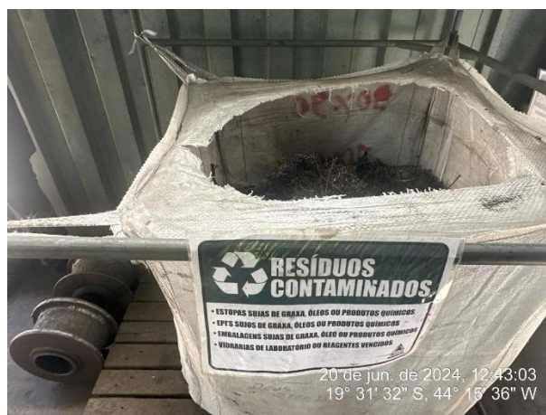
Foto 66: Coletor destinado à armazenagem de limalha oleosa, advinda da atividade de usinagem
