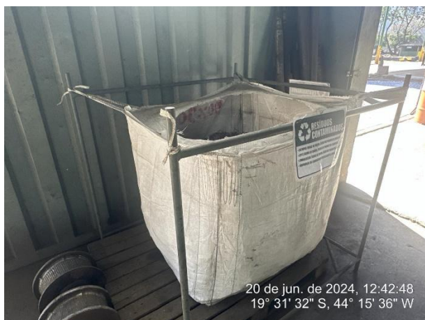
Foto 65: Coletor destinado à armazenagem de limalha oleosa, advinda da atividade de usinagem
