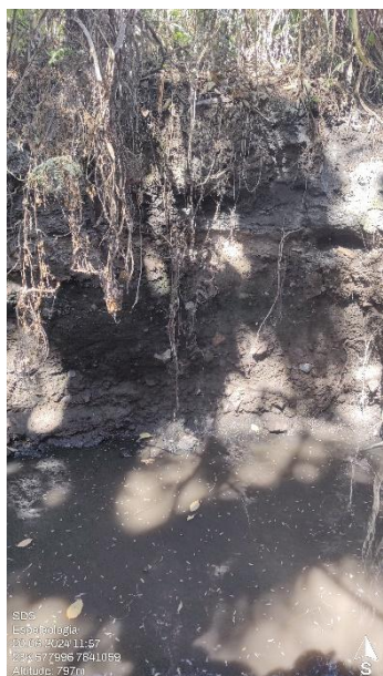
Figura 37. Espesso depósito de “rejeitos” do processo siderúrgico exposto pelo entalhe da drenagem. Podem ser observadas camadas de escória e material de granulometria areia/silte de coloração escura. Ponto 9.
