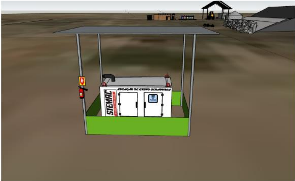
Figura 19: Estrutura a comportar gerador. Fonte: PCA.
