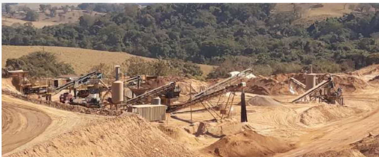
Figura 2 - UTM para beneficiamento a seco do empreendimento
