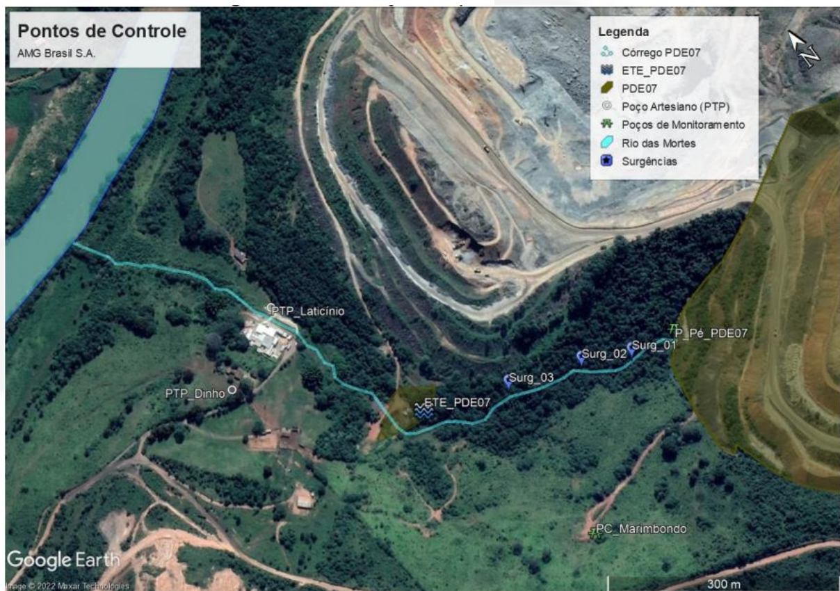
Figura 12: Localização dos pontos de monitoramento da drenagem da PDE07.
