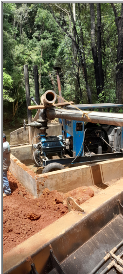
Foto 6: Área de APP à beira do curso d'água com a bomba instalada para captação de água.
