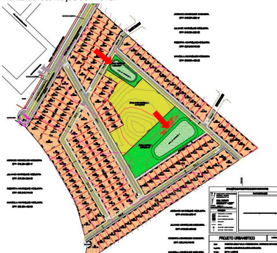
FIGURA 4 – Localização das bacias de contenção para o controle da drenagem pluvial do Residencial Veredas do Campo. Fonte: Datageo urbanismo e gestão de projetos
