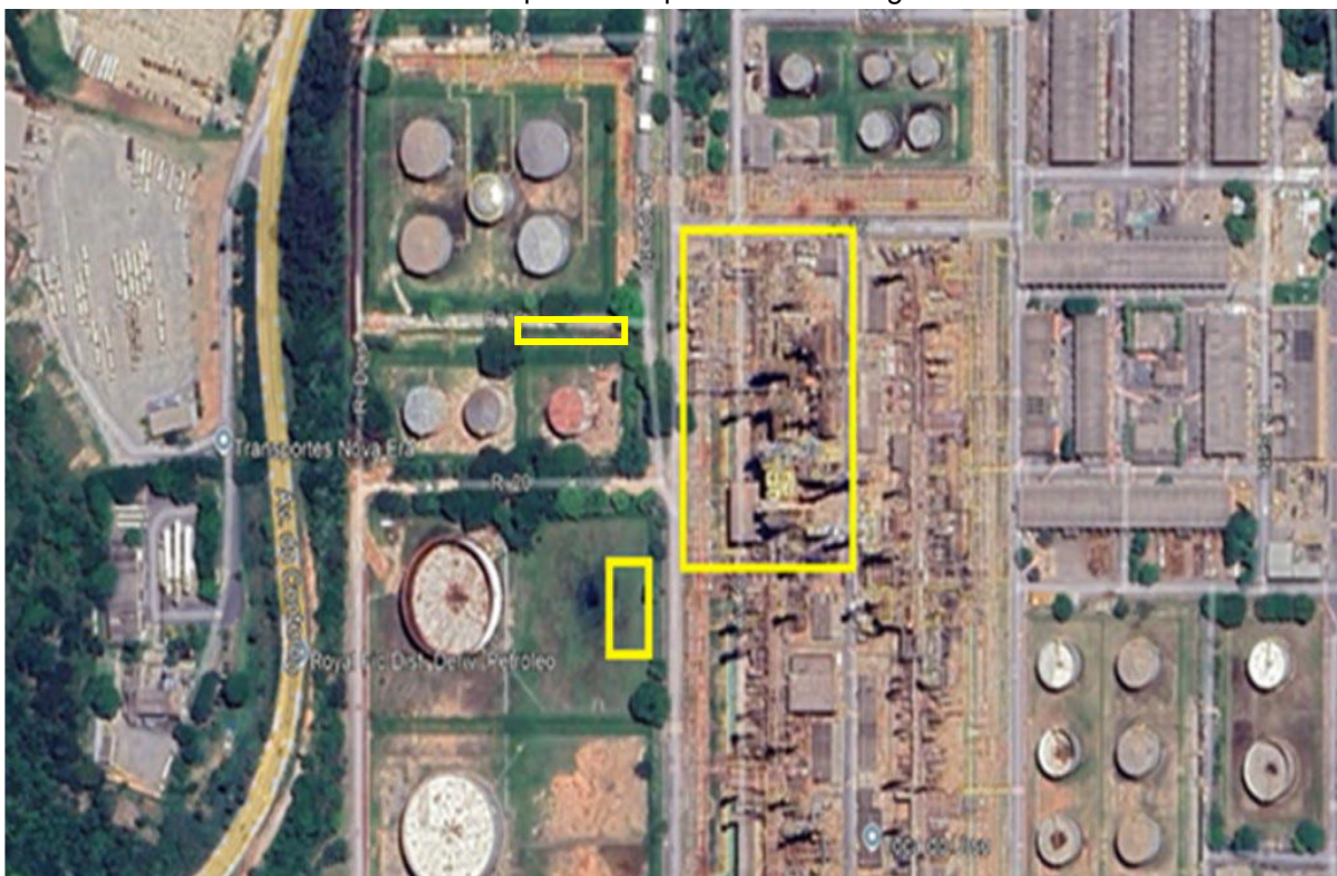
Figura 02: Localização das Unidades de Destilação UDAV's 101/102 internamente a REGAP no retângulo maior e da localização da nova torre de resfriamento proposta nos retângulos menores que mostra um dique de tanque não utilizado gramado.
