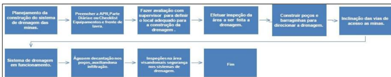
Figura 01: Fluxograma do Procedimento Operacional para construção e manutenção de sistema de drenagens das minas. FONTE: PCA
