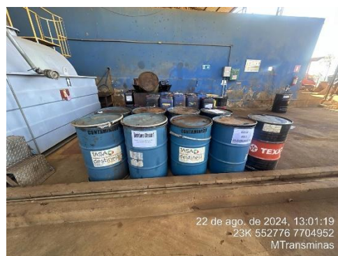
Foto 66: Resíduos perigosos acondicionados na oficina mecânica.
