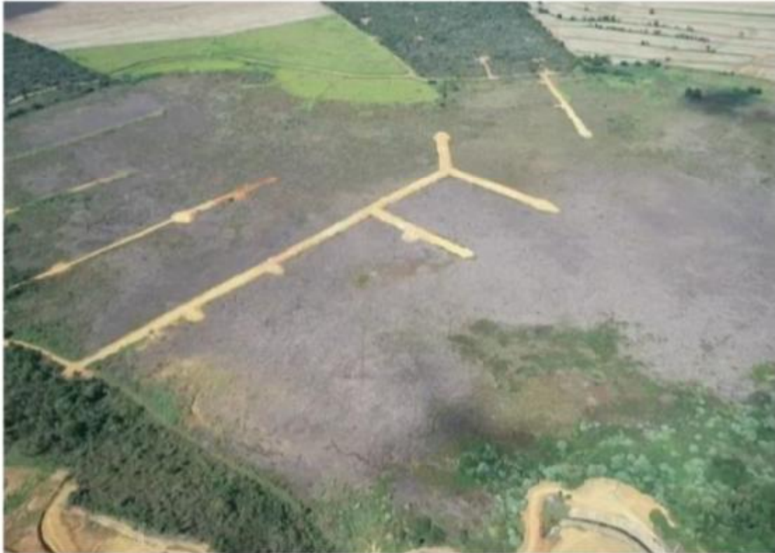
Figura 8- Área úmida alterada pelo rebaixamento do lençol para atividade minerária na Mosac Fertilizantes P&K Ltda. Fonte:EIA/Rima Mosaic (2025).
