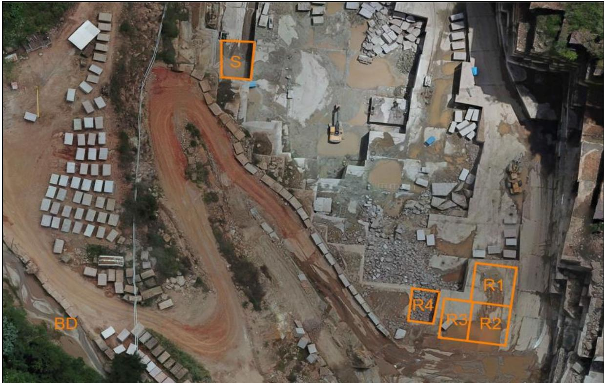
**Figura 31:** Layout com a delimitação dos reservatórios/sumps que serão utilizados no sistema de recirculação.
