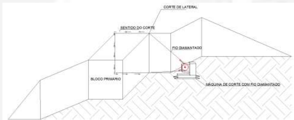
Figura 05: Corte vertical (lateral). Fonte: RCA Fazenda Rio Pardinho.
