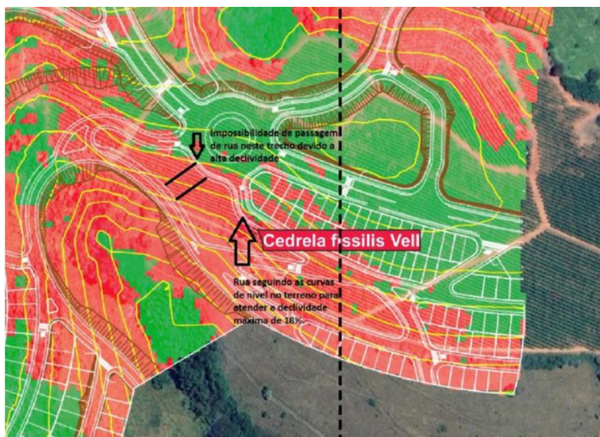
Figura 12 – Ligação com a rotatória seguindo as curvas de nível devido a declividade acentuada no entorno. Fonte: EIATL
