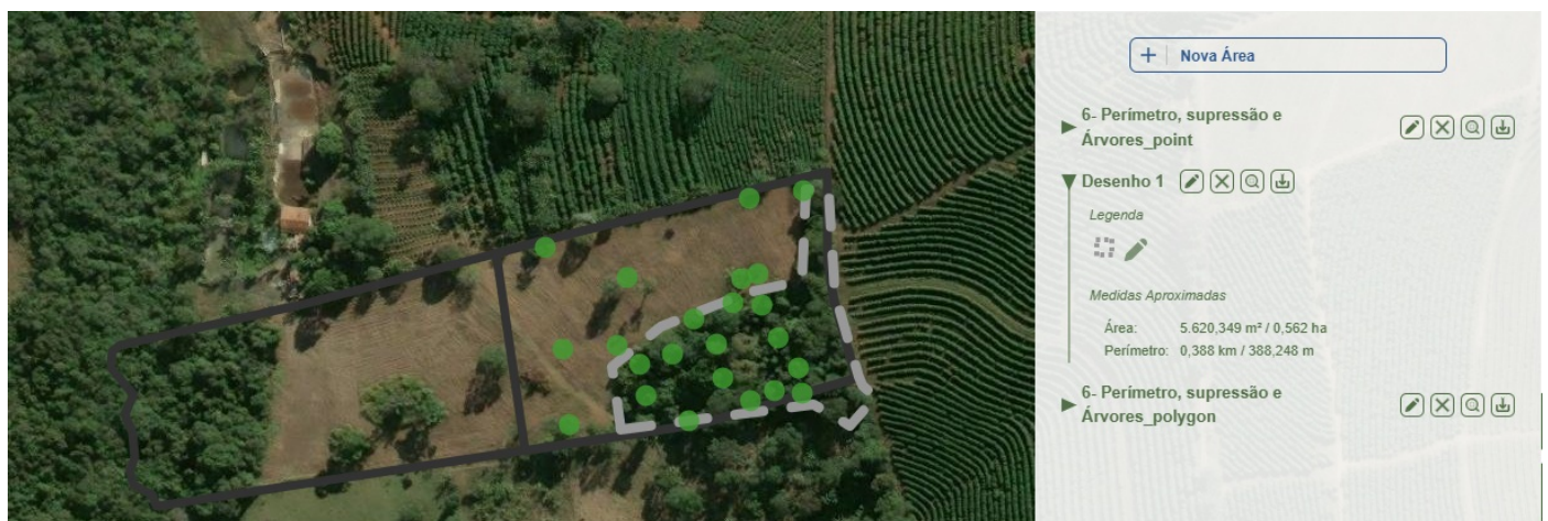
Figura 1. Poligonal de perímetro da propriedade e supressão de árvores nativas em preto, pontos verdes representando as árvores solicitadas para corte e poligonal pontilhada de delimitação de remanescente florestal com 0,562 ha.
