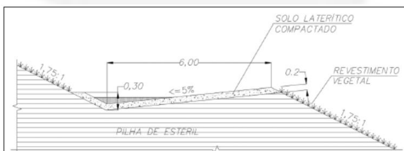
Figura 9. Apresentação da drenagem superficial da pilha.
