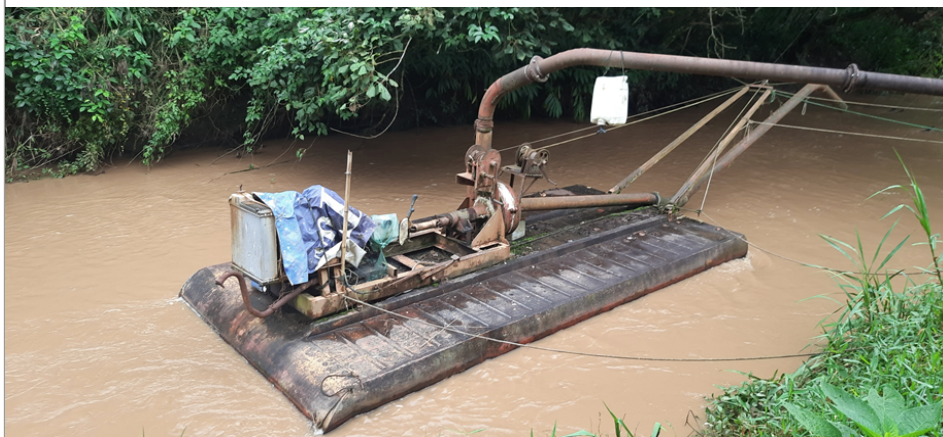
FIGURA 11: Imagem da draga de extração mineral sobre o Rio Mogi Guaçu no Sítio Santo Antônio, Bairro Santo Antônio, município de Tocos do Mogi/MG.
