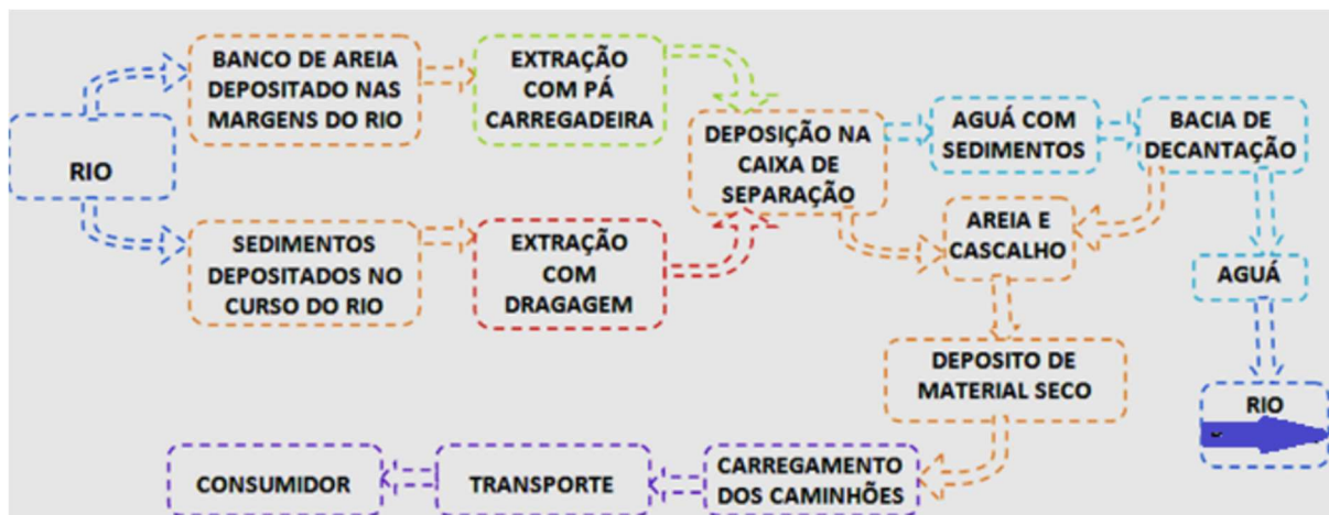
Figura 4: Etapas da extração da areia e do cascalho
