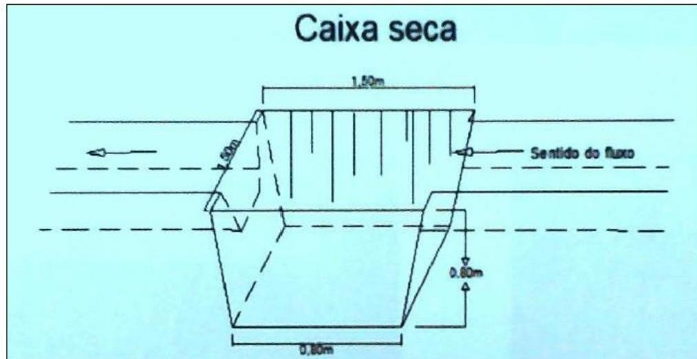
Figura 10: Modelo de caixa seca. Fonte: PCA, 2023.
