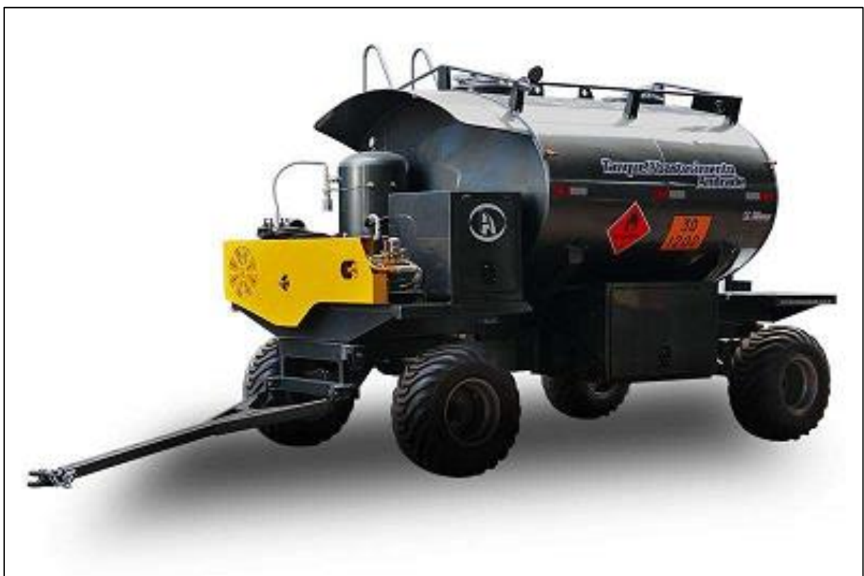
Figura 3: Ilustração do tanque móvel de abastecimento.
