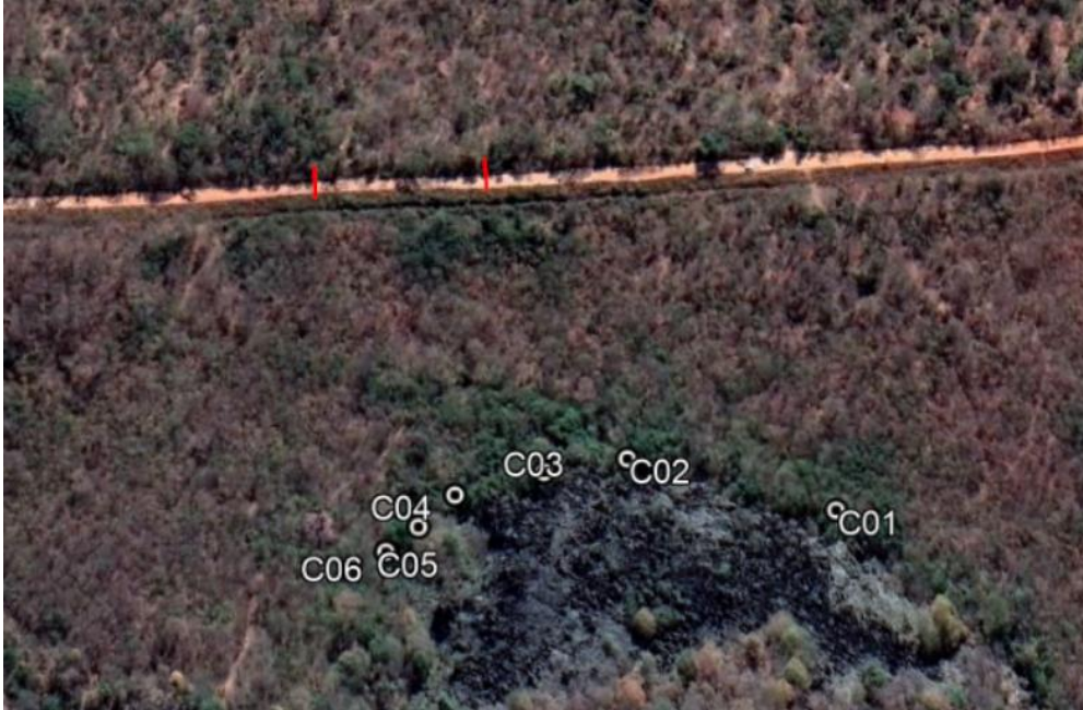
Figura 12 Localização das cavidades em relação ao bueiro (linha na cor vermelha) localizado nas estacas 809 e 813+10.
