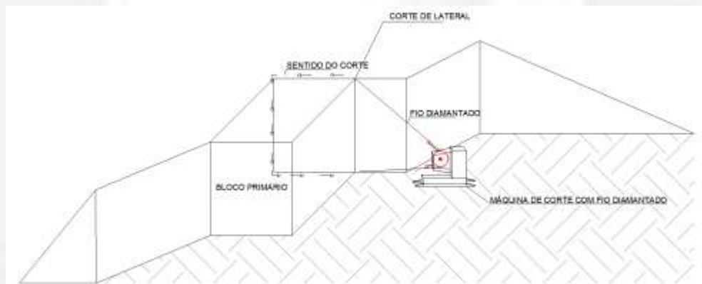
Figura 04: Corte vertical (lateral). Fonte: RCA Fazenda Morro Agudo.
