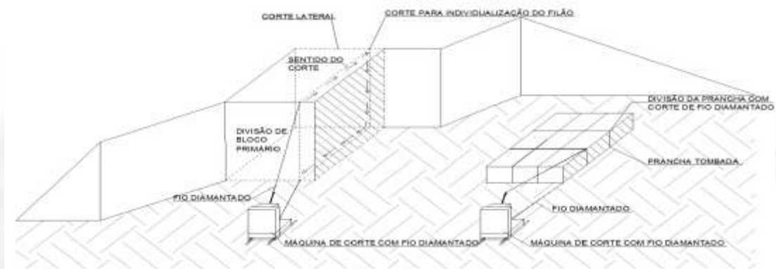
Figura 06: Divisão do bloco primário em filão que após tombado denomina-se “prancha”. Fonte: RCA Fazenda Buraquinho.
