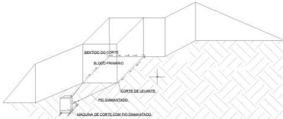
Figura 05: Corte horizontal (levante). Fonte: RCA Fazenda Buraquinho.
