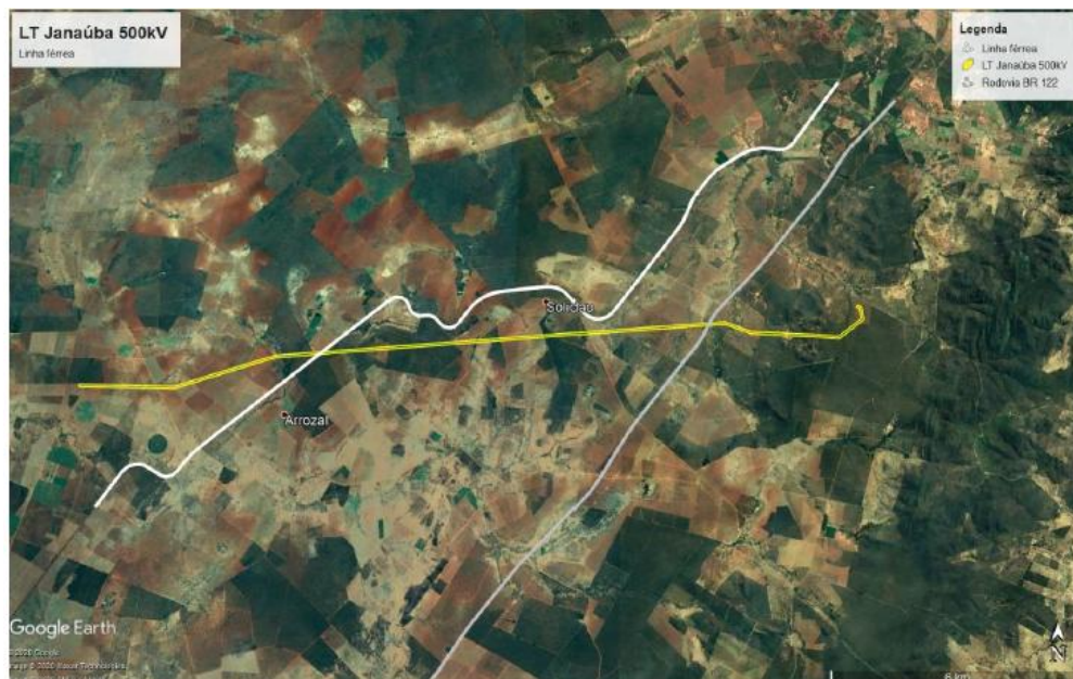
Figura 2. Interferência da LT sobre linha férrea e rodovia. Fonte: JX Assessoria Ambiental (2020).
