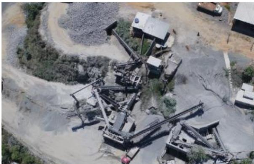
Parte do setor de britamento - Rebritagem (britadores secundário e terciário). Fonte: EIA/RIMA
