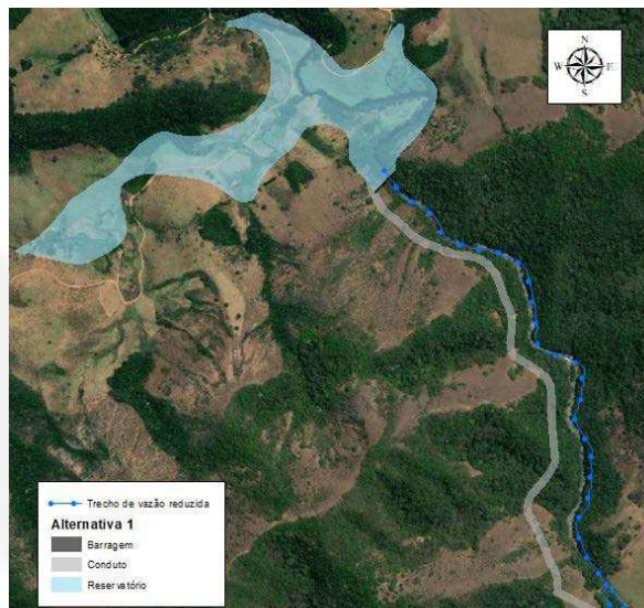
Imagem 02: Utilização de barragem com reservatório seguido por conduto até a casa de força.
