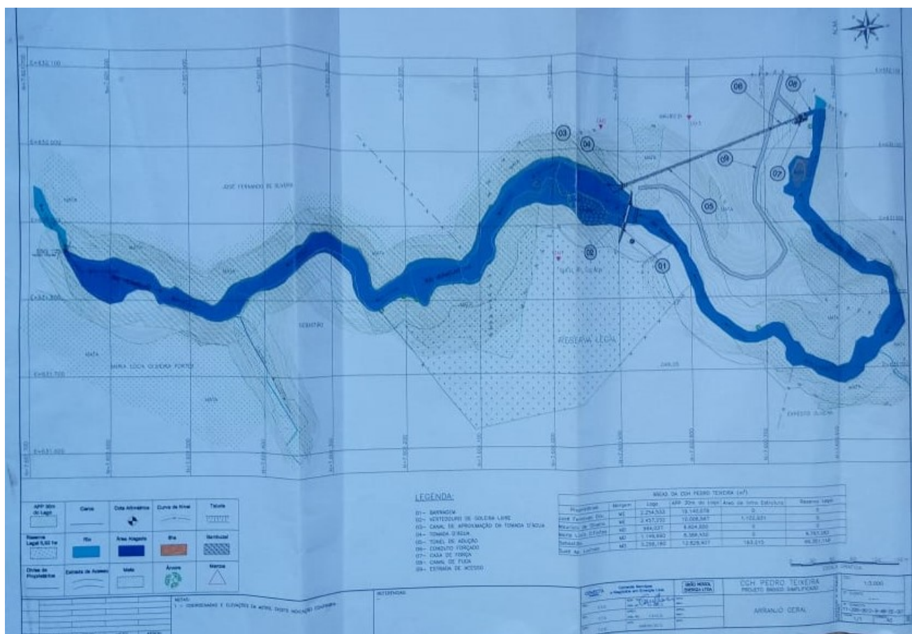
Figura 03: Foto tirada da Planta do arranjo geral apresentada no processo de LP+LI. Em azul escuro está representado o reservatório formado a partir da área alagada e em azul claro está representada a calha do Rio Vermelho.
