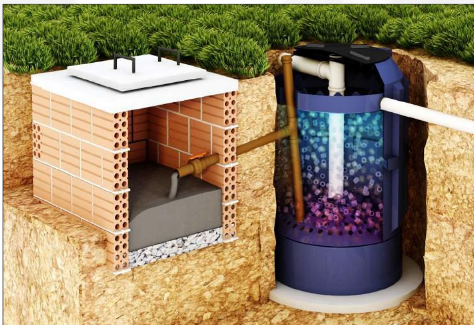
Figura 34 - Modelo de biodigestor e leito de secagem.
