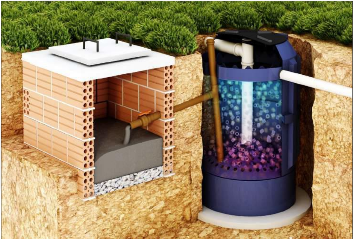
Figura 10: Modelo de biodigestor e leito de secagem.
